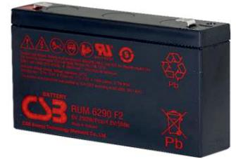
Аккумуляторные батареи CSB серии UPS (RUM) - серия батарей со сроком службы до 5 лет (или до 260 циклов до 100% разряда при работе в циклическом режиме), высокой мощности при малых массогабаритных показателях. Как и батареи других серий CSB они являются необслуживаемыми - выполнены по AGM-технологии, герметизированы- работоспособны в любом положении, безопасны в эксплуатации, имеют низкий уровень саморазряда, высоконадежны.
